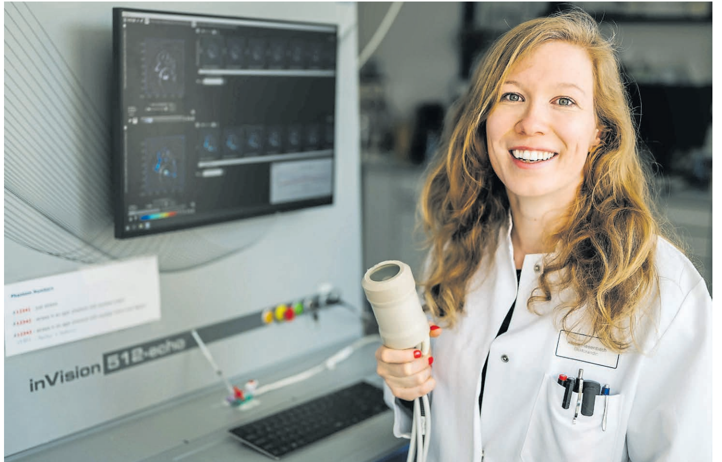
Doktorandin Alexa Hasenbach mit dem Fotoakustik-Detektorkopf, der Laserlicht ins Körpergewebe aussendet.
